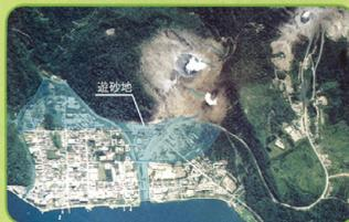
この被害を踏まえ、土砂災害から洞爺湖温泉街を守るため、大規模な遊砂地が建設されました。左の図の青色で示したアパートなどの建物は移転し、土砂をため込む施設となりました。
