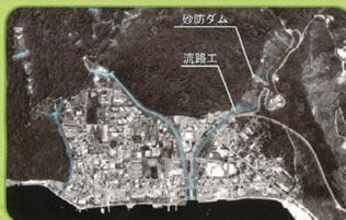
1977～1978年噴火後、泥流や土石流から洞爺湖温泉街を守るため、砂防施設がつけられました。温泉街の上流側で土砂を押しとどめるために砂防ダムが建設され、泥流や洪水を安全に流すために流路工が設けられました。
